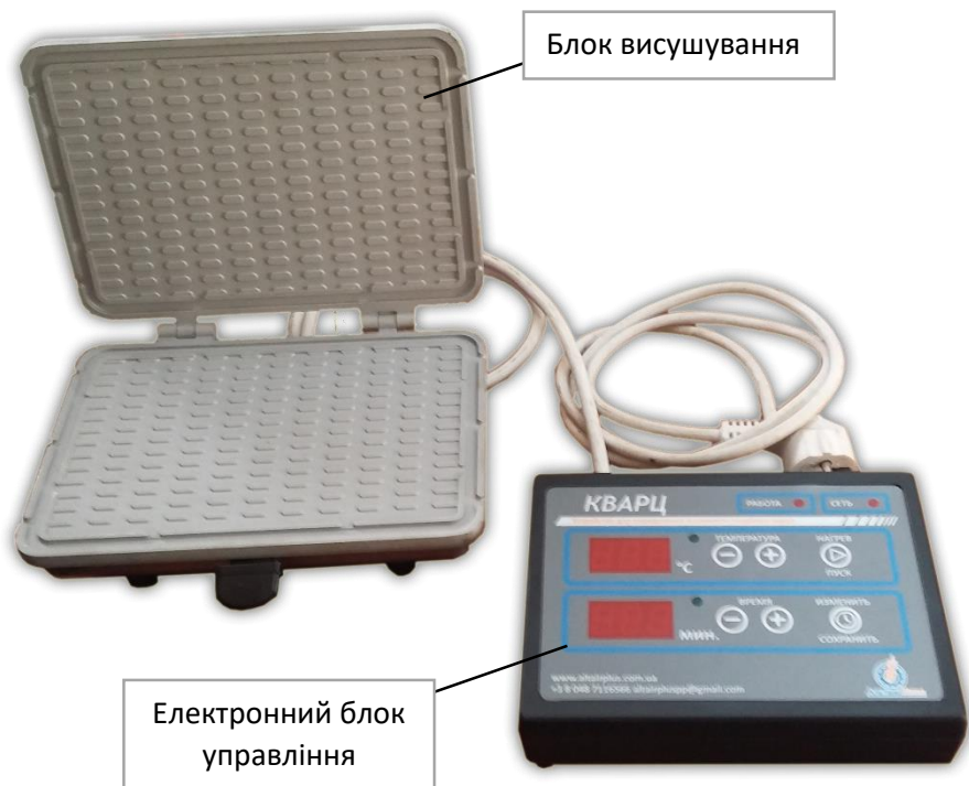
Мал. 1 – Зовнішній вигляд та призначення вузлів пристрою.
